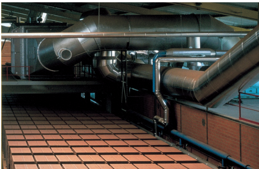
Bild 28 Abwärme aus dem Tunnelofen wird über Kraft-Wärme-Kopplung zum Betrieb der Ventilatoren des Trockners genutzt.
