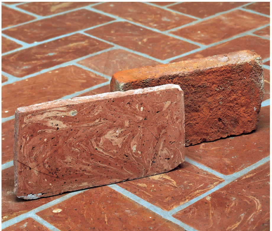
Bild 15 Wiederverwertung von Abbruch-Ziegeln als hochwertiger Bodenbelag.
