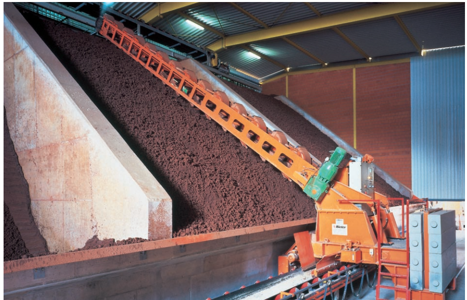
Bild 26 Homogenisierung des Tons im Sumpfhaus.
